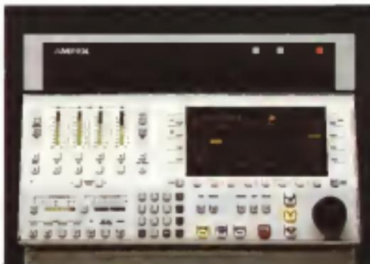
Una delle macchine D1 attualmente in produzione è il modello VPR 200 della Ampex
